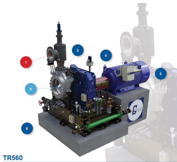
Obr. 2: 1 – vstup pary; 2 – výstup pary; 3 – Turbínová skriňa; 4 – Prevodovka; 5 – Generátor; 6 – Základový rám
