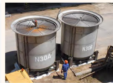
Nové rúrkové zväzky kotlov
