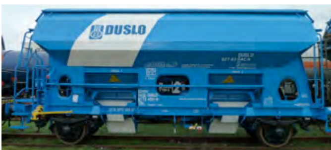
Obr. 3: Vozň Tdns na prepravu voľne uložených substrátov
