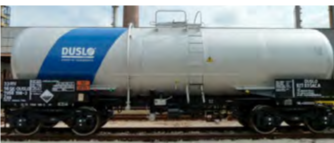
Obr. 5: Štvornápravový nádržkový vozeň na prepravu kyseliny dusičnej – rekonštruovaný v roku 2016
