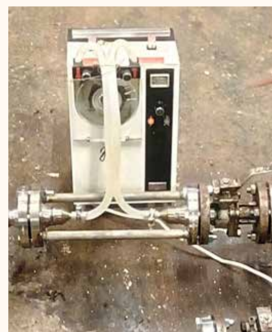
Peristaltické čerpadlo na dávkovanie kyseliny mravej
